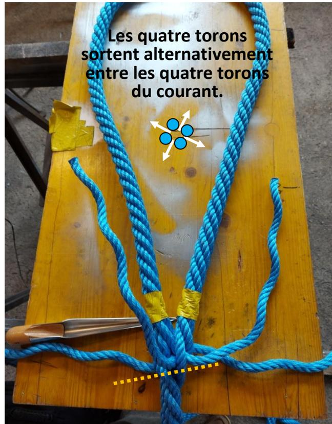
Une fois la première passe réalisée, égaliser autant que possible la "hauteur" de sortie des quatre torons. Çà devient plus clair ensuite !
